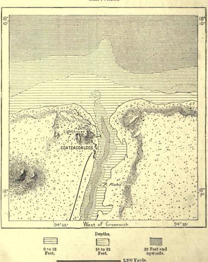
Fig. 18.—COATZACOALCOS BAR. Scale 1 : 60,000.
