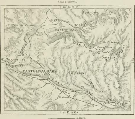
Fig. 79.—Rigoles of the Canal Du Midi.
